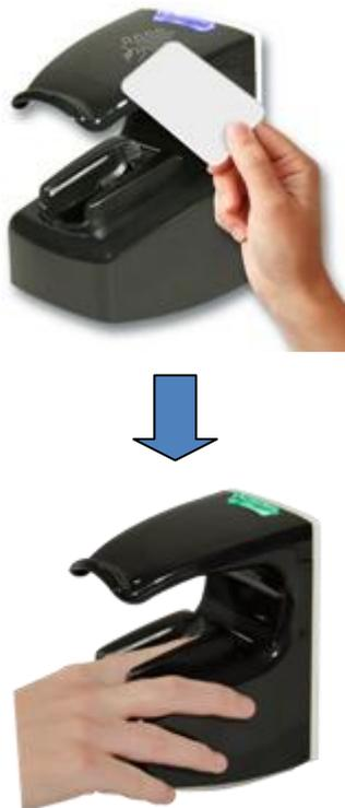
**Figure 29 : Mode authentification avec données biométriques sur la carte**
