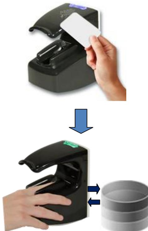
**Figure 30 : Mode authentification avec données biométriques dans la base**
